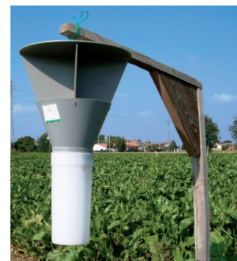
Foto 1. Trappola a feromoni per la cattura di una singola specie di nottua
